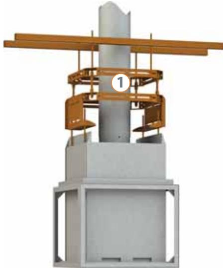
**Module 1** - de base - facilite et sécurise la pose des foyers suspendus et permet de régler tous les écarts de niveaux pendant et même après l'installation. Hauteur sous plafond de 190 cm à 209 cm\* (4 faces 700) ou 200 à 219 (4 faces 800 et panoramique).
